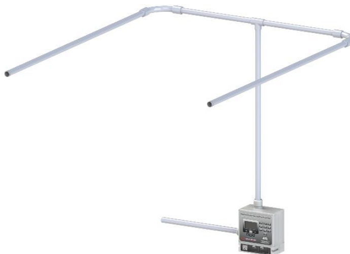
Рисунок 4 – Воздухозаборный трубопровод с 2 симметричными ветвями
