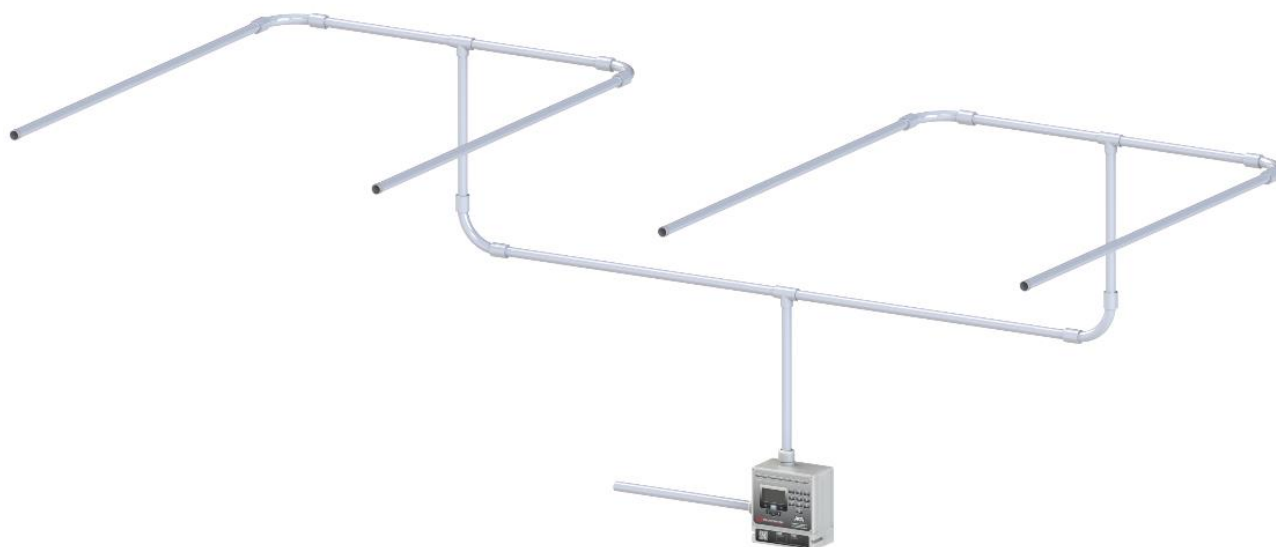
Рисунок 5 – Воздухозаборный трубопровод с 4 симметричными ветвями
